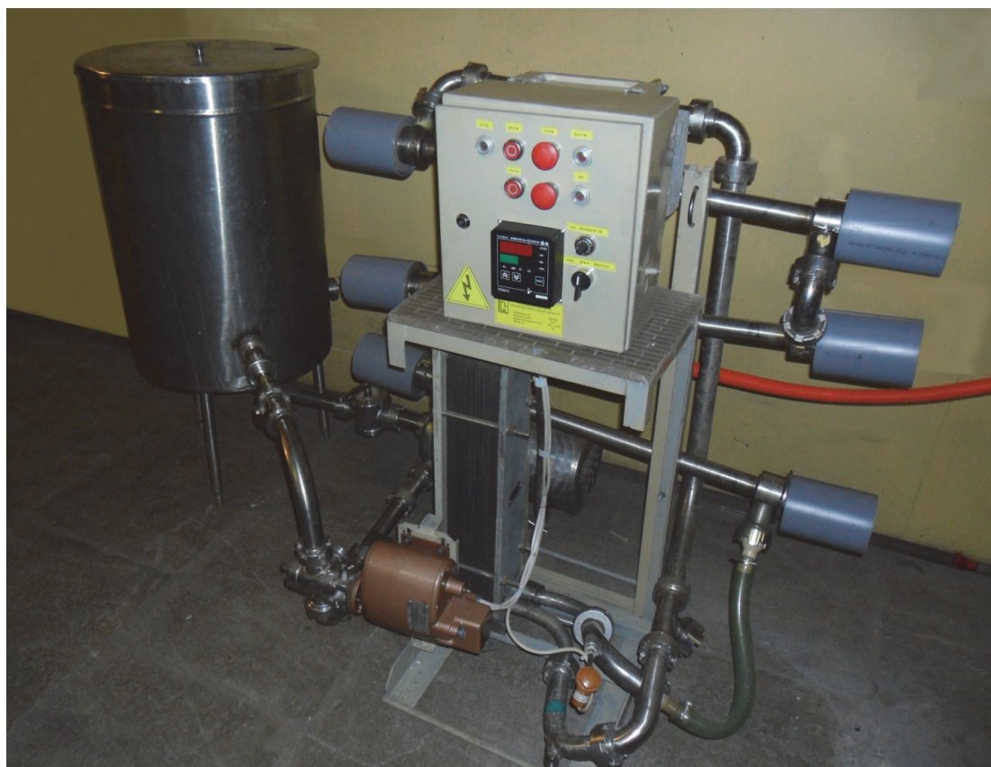
Рис.2. Установка для ИК пастеризации жидкости в тонком слое
