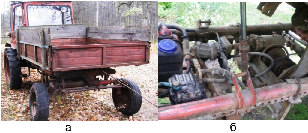
Рис. 1. Натурна модель лісової машини із однобарабанною лебідкою: а – загальний вигляд; б – розташування елементів привода лебідки.
