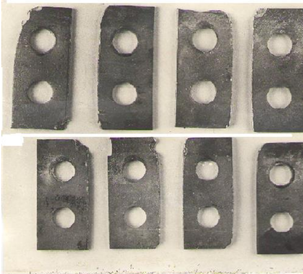
Рис. 1. Характерні типи експлуатаційних пошкоджень молотка кормодробарки ДБ-5 після подрібнення 50–60 тонн зерна (матеріал молотка – сталь 65Г).
