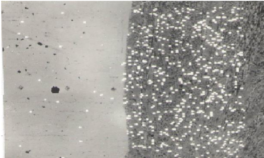
Рис. 5. Глибина проникнення хрому (дифузійна зона) в основу молотка, x1000.
