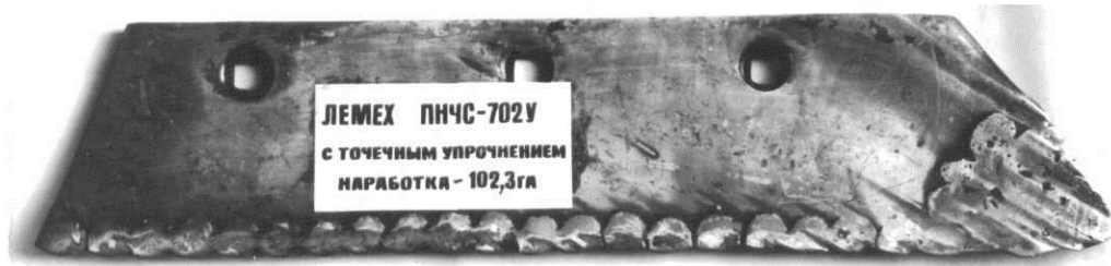
Рис. 3. Леміш з точковим зміцненням після наробітку 102,3 га.
