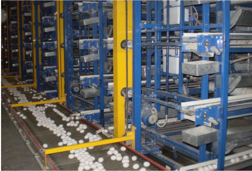
Рис. 3. Система збору яєць обладнання ТБК ДН.
