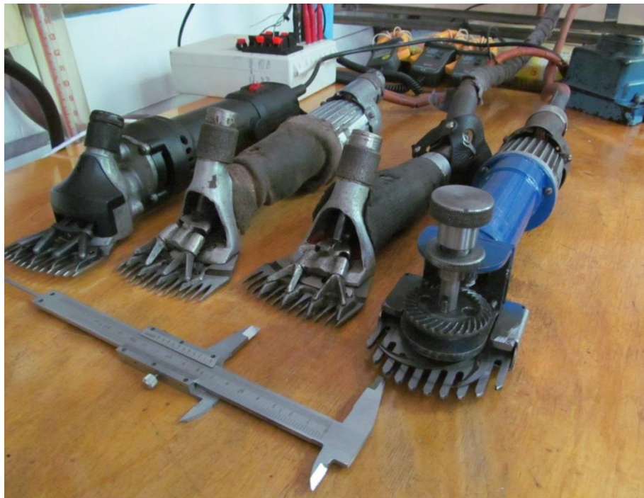
Рис. 1. Досліджувані стригальні машинки: з права на ліво: N1J-GM01-76, МСУ-200, МСО77В та стригальна машинка ротаційного типу.
