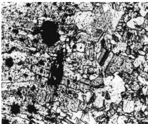
Рис. 4 Мікроструктура контакту із матеріалу CrM-0,2 після 1 \times 10^5 комутацій, \times 200 .
