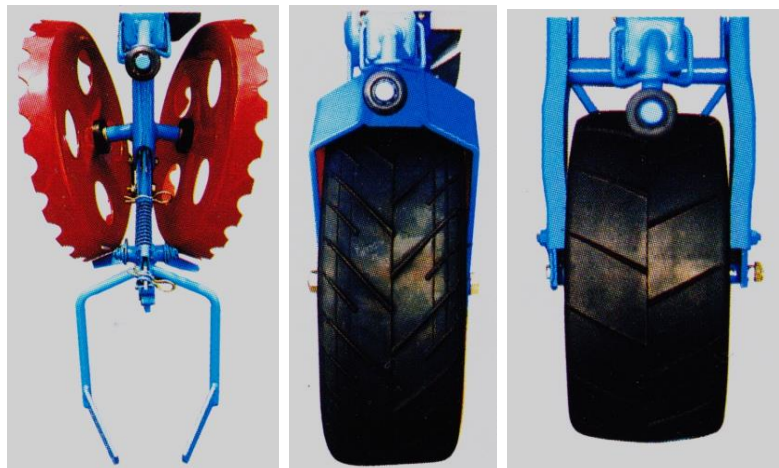
Рис. 7. Елементи сошникових систем сівалок «Моносем».
