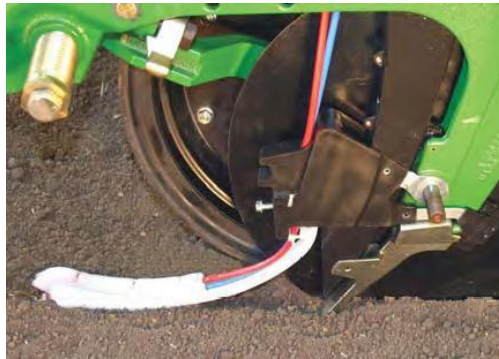
Рис. 4. Полозок Keeton Seed Firmer від Precision Planting.
