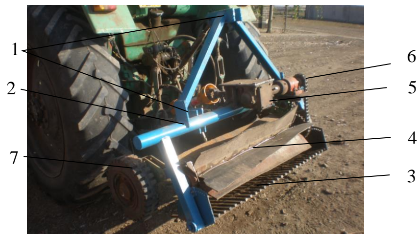
Рис. 3. Експериментальна установка: 1 – навісний пристрій; 2 – рама; 3 – викопуючі робочі органи (набір доліт); 4 – бітер; 5 – редуктор; 6 – привід; 7 – опорне колесо.
