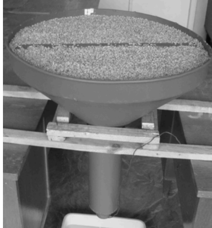
Рис. 2. Експериментальний зразок дозатора насіння з зерном.
