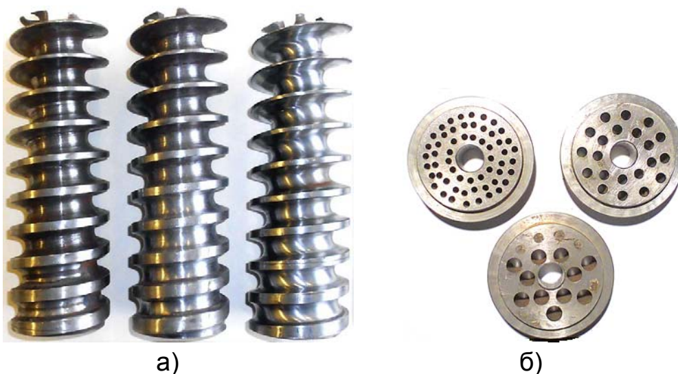
Рис. 3. Гвинти з різною інтенсивністю зміни розмірів каналу за довжиною (а) та матриці з різною кількістю отворів які мали різні діаметри (б).
