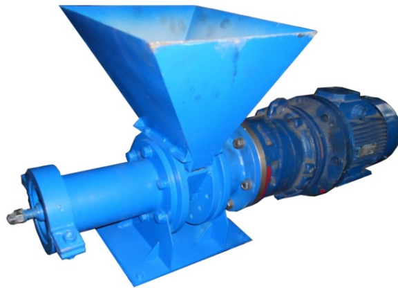
Рис. 2. Експериментальний зразок гвинтового гранулятора кормів.
