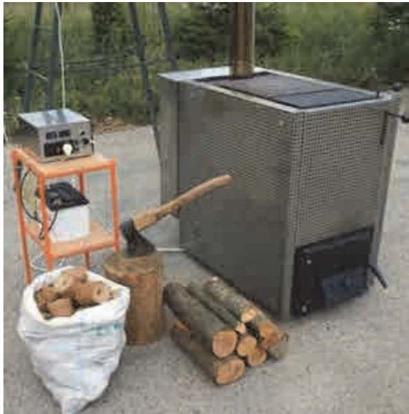
Рис. 3. Виставочний зразок теплогенератора потужністю 30 кВт
