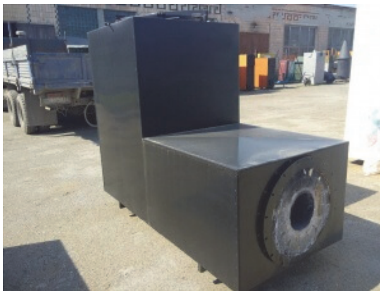
Рис. 2. Піролізний генератор-утилізатор відходів потужністю 0,5 МВт
