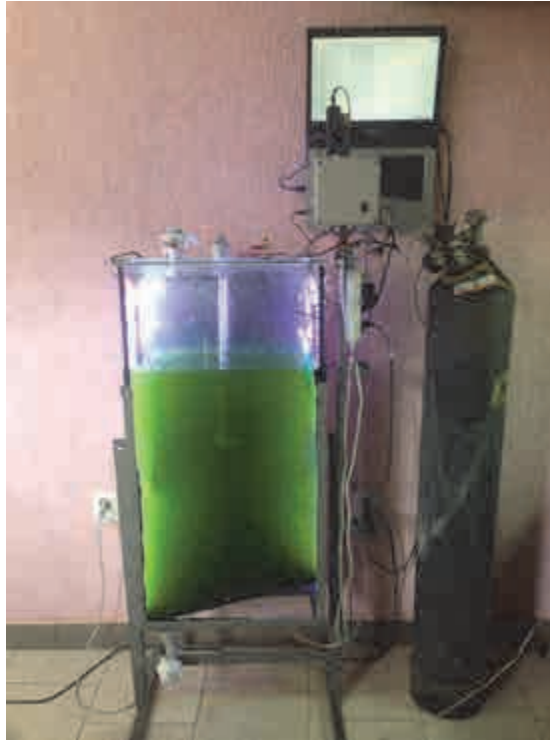
Рис. 4. Лабораторна установка біотехнологічного комплексу на базі фотобіореактора
