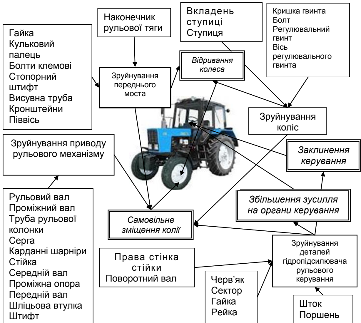
Рис. 3. Блок-схема створення аварійних ситуацій через зруйнування деталей рульового керування трактора МТЗ-80.
