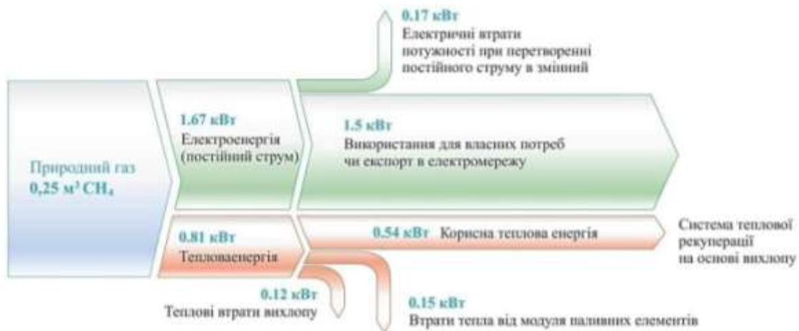
Рис. 2. Енергетичний баланс ринкової установки BlueGEN на базі ТОПЕ потужністю 1,5 кВт
