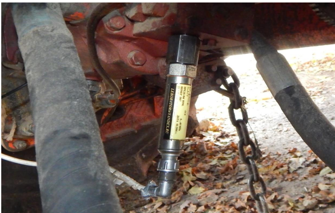
Рис.1. Место установки датчика высокого давления на комбайне Дон-1500Б.
