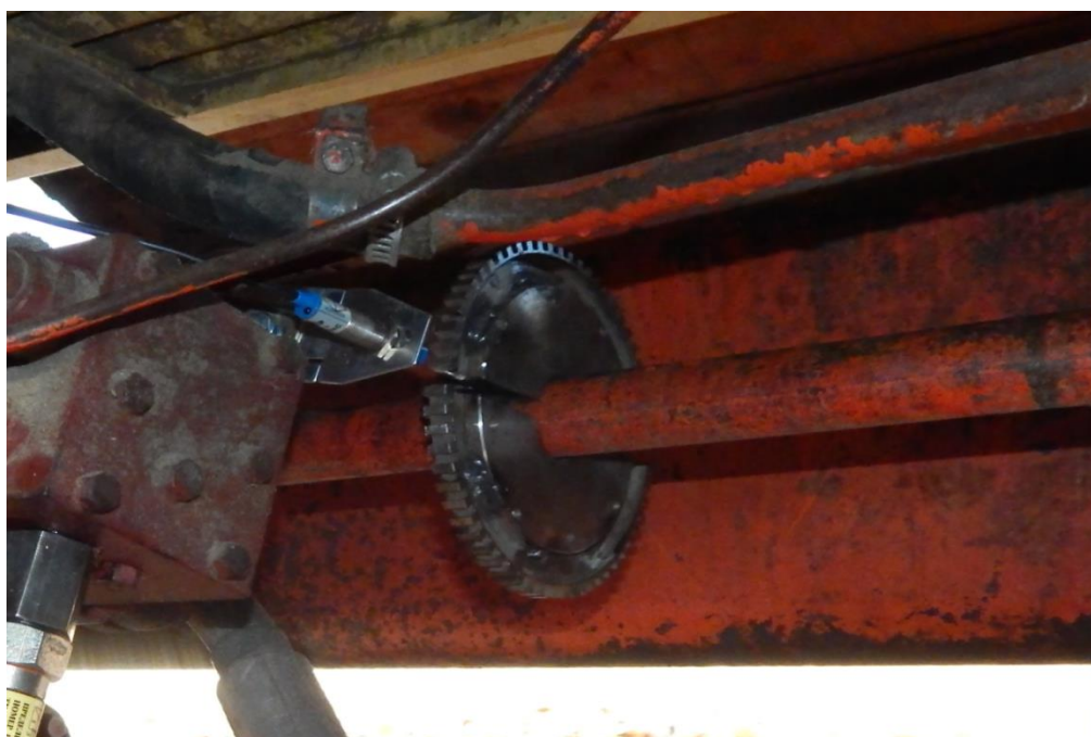
Рис. 2. Место установки индукционного датчика оборотов вала гидромотора на комбайне Дон-1500Б.
