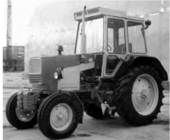
Рис. 1. МЕЗ класичного компонування: а – принципова схема; б – загальний вигляд; 1 – місце для агрегування технологічних модулів.
