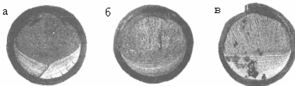
Рис. 2. Характерные изломы болтов: №1 (а), №2 (б), №4 (в).
