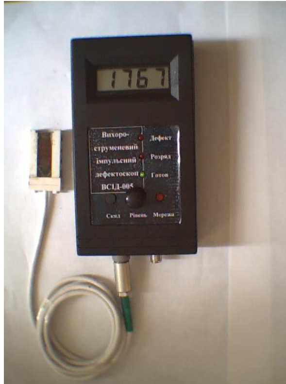
Рис. 1. Зовнішній вигляд вихорострумового імпульсного дефектоскопа для виявлення малих експлуатаційних тріщин.
