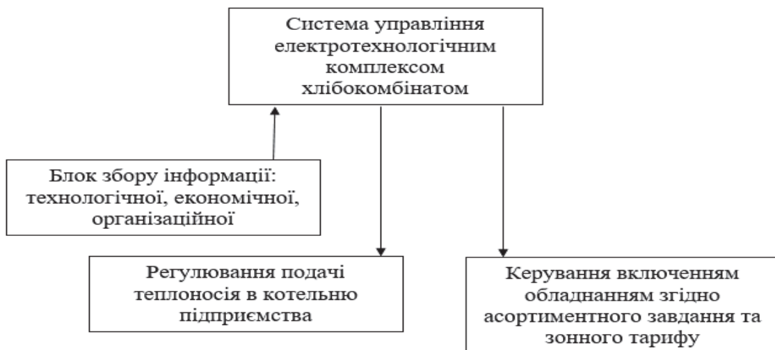
Рис. 1. Схема функціонування системи управління електротехнологічним комплексом хлібокомбінату
