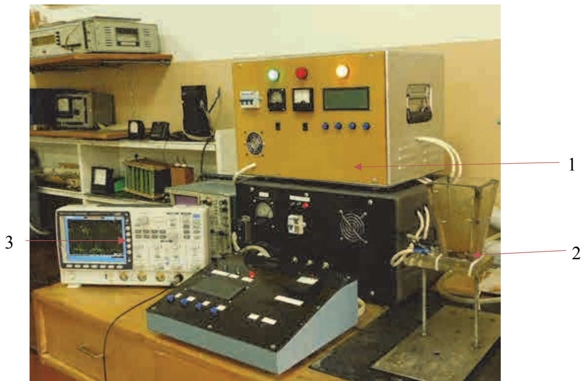
Рис. 1. Електротехнічний комплекс отримання нано- і мікропорошків металів:
