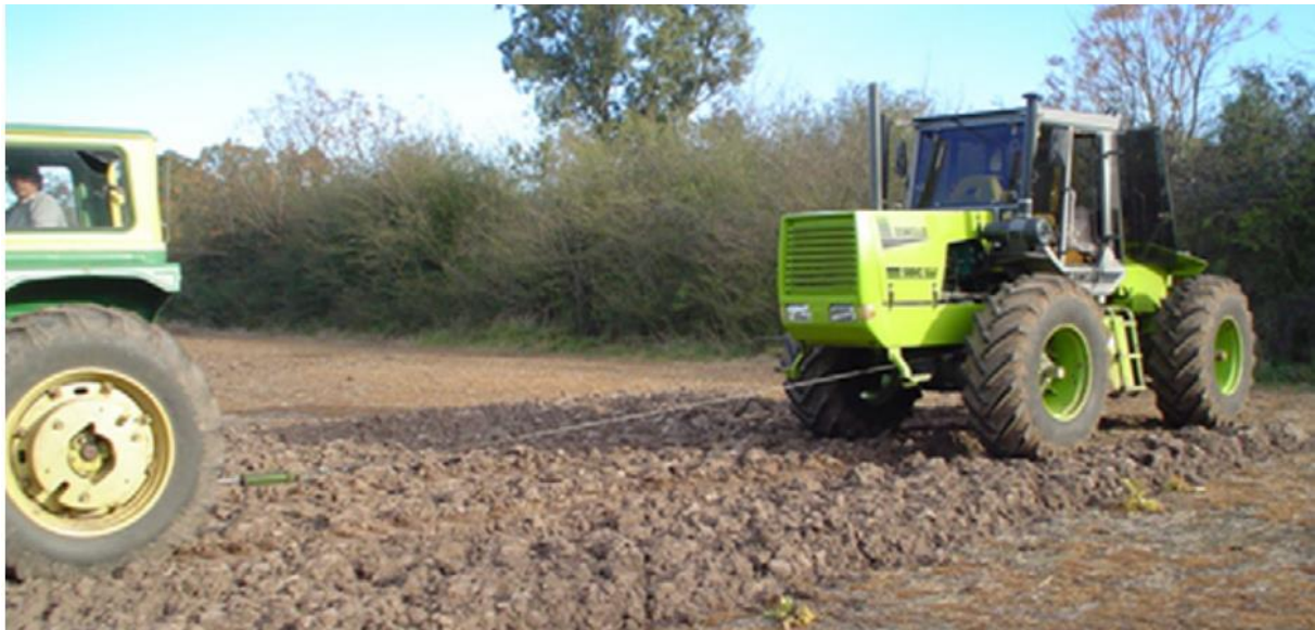
Рис. 1. Вимірювання опору перекочуванню енергозасобу.
