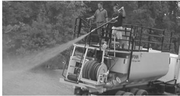
Рис. 1. Гідропосів сміттєзвалища за допомогою гідросівалок "FINN"
