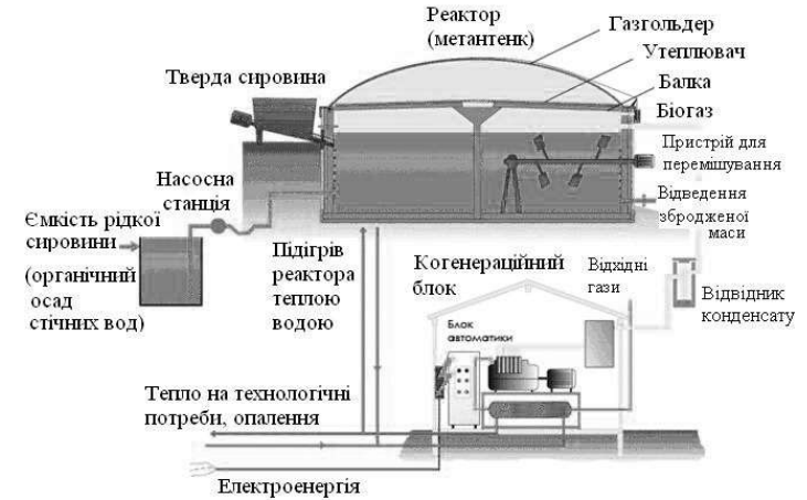
Рис. 2. Принципова схема дії біогазової установки [5]
