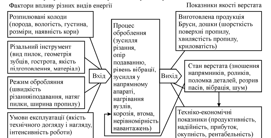
Рис. 2. Загальна схема взаємодії чинників у процесі експлуатації стрічкопилкового верстата
