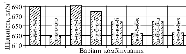
Рис. 4. Вплив варіанта комбінування пакета шпону на щільність фанери
