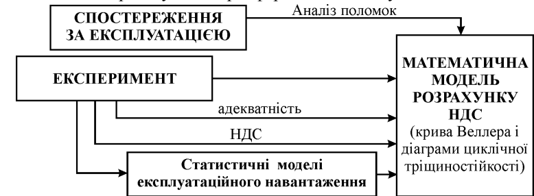
Рис. 2. Структурна схема проектування грейферних навантажувачів
