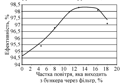
Рис. 4. Вплив частки повітря, яке виходить в атмосферу через фільтрувальний рукав, який встановлено на бункері, на ефективність
