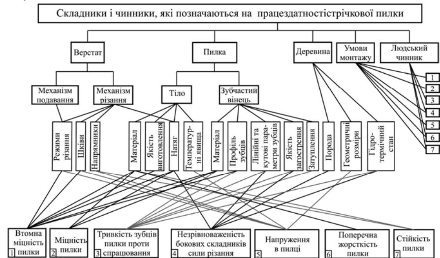
Рис. Складники та чинники, які позначаються на працездатності стрічкової пилки
