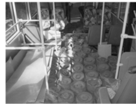
Рис. 3. Салон завантаженого автобуса (маса 14960 кг)
