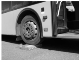
Рис. 5. Збурення власних крутильних коливань
