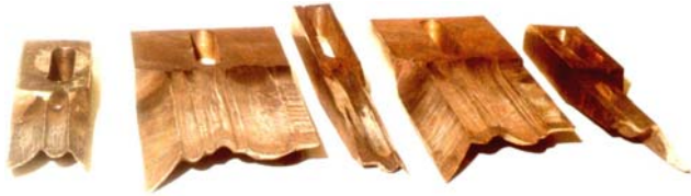
Рис. 2. Загальний вигляд зміцнених комплексною (ЕІЛ+ОКГ) обробкою фасонних різців для точіння ніжок столів та стільців
