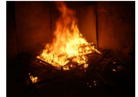
Рис. 4. Вогнище пожежі під час виконання експериментальних досліджень в закритому приміщенні
