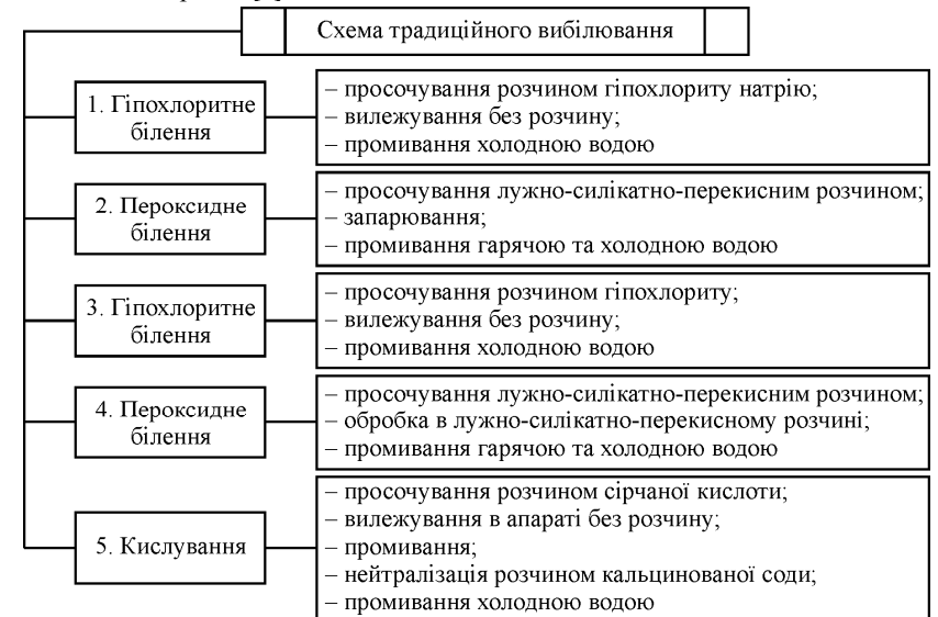
Рис. 1. Схема традиційного вибілювання лляної тканини на п'ятисекційній лінії ЛЖО-1-Л
