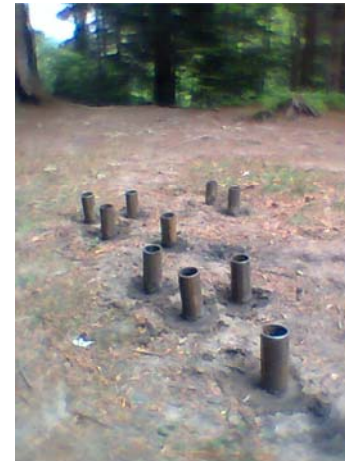
Рис. 1. Проведення дослідження водопроникливості ґрунту методом трубок у місцях інтенсивного рекреаційного навантаження
