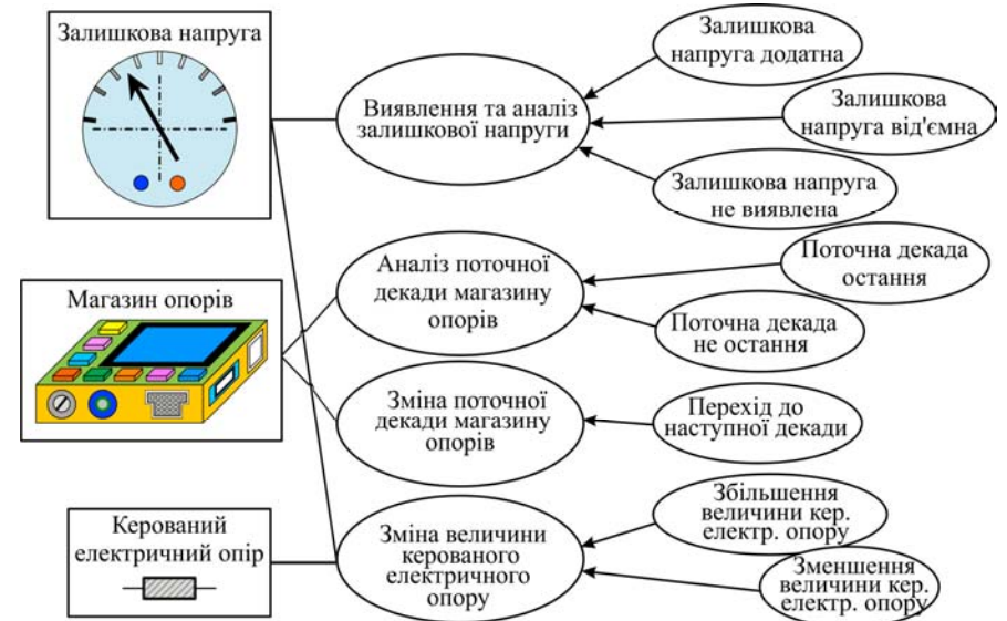
Рис. 4. UML use case – діаграма ПЗ мікроконтролера СКС
