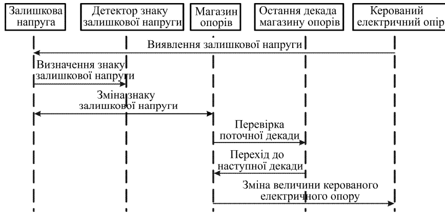
Рис. 5. UML – sequence diagram ПЗ мікроконтролера СКС
