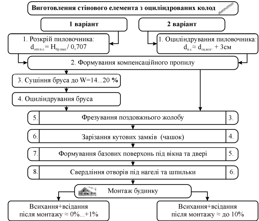
Рис. 1. Структурна схема виготовлення стінового елемента (оциліндрованої колоди)
