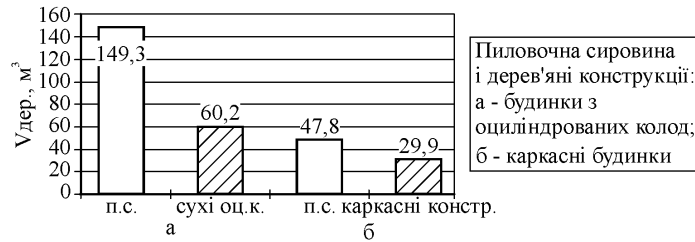
Рис. 5. Витрати пиловочної сировини і дерев'яних конструкційних елементів на: а – будинки з оциліндрованих колод; б – каркасні будинки
