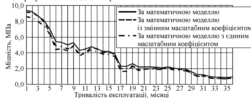
Рис. 1. Прогнозування міцності для структурованих термопластичних клейових з'єднань дуба з використанням масштабного коефіцієнта
