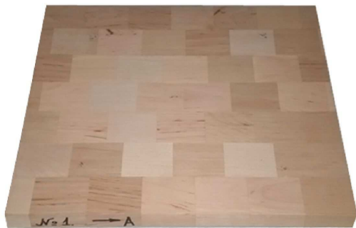
Рис. 1. Загальний вигляд експериментального зразка №1 клеєного щита, виготовленого із структурних одиничних елементів
