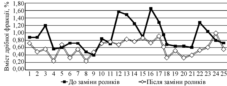
Рис. 2. Залежність вмісту дрібної фракції від технічного стану роликів
