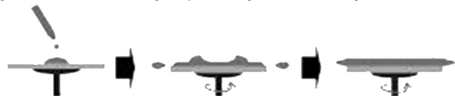
Рис. 2. Схема методу спінового покриття (SpinCoating)
