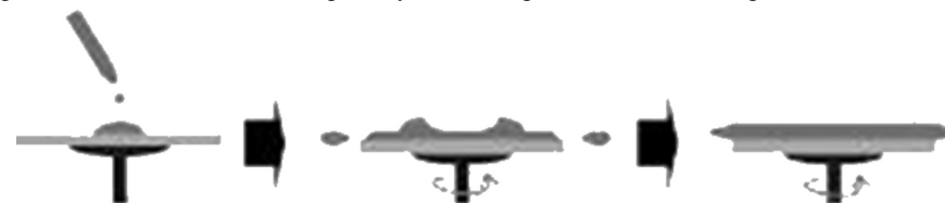
Рис. 2. Схема методу спіно-покриття (SpinCoating)
