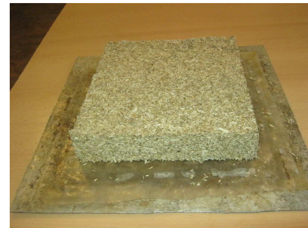
Рис. 2. Зовнішній вигляд стружкового пакета під час виготовлення дослідних зразків деревинно-композиційного матеріалу
