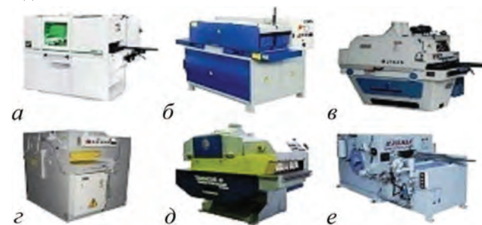
Рис. 1. Загальний вигляд круглопилкових верстатів прохідного типу: а) Raimann UniRip 310 фірми "WEINIG" (Німеччина); б) WD-400 фірми "Walter" (Польща); в) MJ-143E фірми "Qving Cheng" (Китай); г) ВД-100 фірми івеціспеціалмаш" (Україна); д) ЦДК 5-3 фірми "ТСЗ" (Росія); е) RM HCD фірми "RULMAK" (Туреччина)
