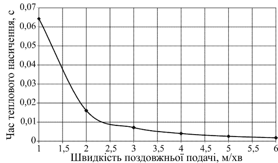
Рис. 3. Залежність часу теплового насичення від лінійної швидкості абразивного круга
