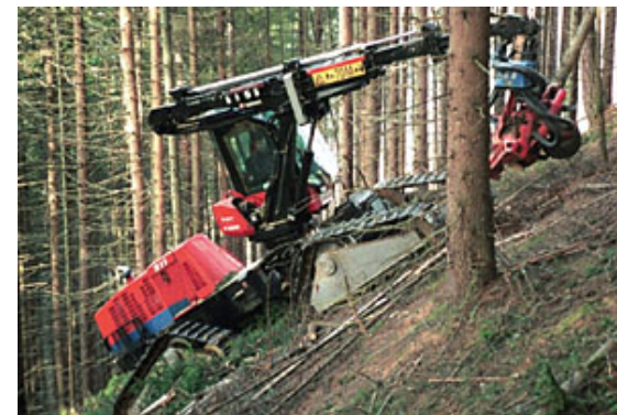
Рис. 3. Гусеничний харвестер "Valmet 911 X3M" на стрімкому схилі [5]
