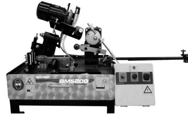
Рис. 2. Верстат BMS-200 для загострювання вузької стрічкової пилки повнопрофільним кругом
