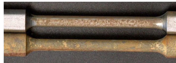
Рис. 2. Характер корозійних уражень після витримки в гідраті протягом 7 днів за схемою 1) верхній зразок, за схемою 2) нижній зразок
