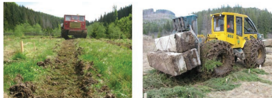
Рис. 4. Полігонні дослідження взаємодії трелювальних тракторів TT-4 і HSM-805 з опорною поверхнею
