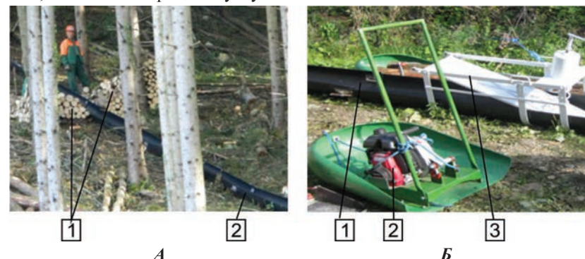
Рис. 2. Пластикові лоткові системи: А) підготовлена до спуску деревини пластикова лоткова система: 1) штабель деревини; 2) змонтований для спуску деревини лоток; Б) елементи пластикової лоткової системи: 1) пластиковий лоток; 2) встановлена на пені мотолєбідка; 3) гальмівний пристрій
