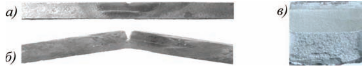
Рис. 4. Загальний вигляд зразка до (а) та після (б, в) експерименту з дослідження умов спонтанного руйнування трубної сталі 20
