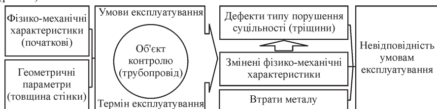
Рис. 1. Схема взаємозв'язків умов експлуатування з параметрами, що характеризують технічний стан лінійної частини магістральних трубопроводів
