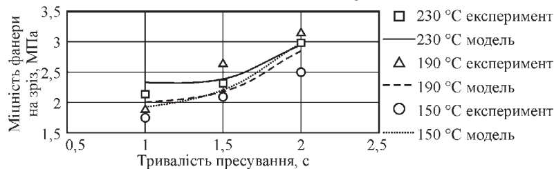
Рис. 3. Залежність міцності фанери від тривалості пресування за тривалості ІЧ прогрівання \tau_{прог} = 30 с
